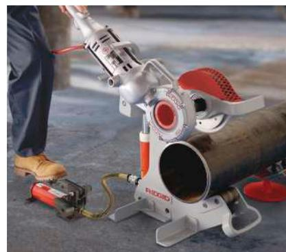
Coupe-tubes modèle 258 utilisant le moteur 700 Power Drive pour la coupe
