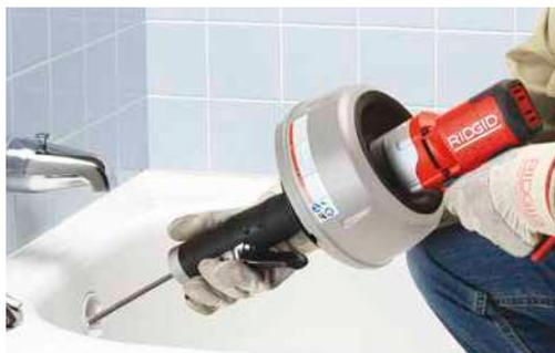
Le modèle K-45AF libère rapidement les conduites de sanitaire colmatées. Avance et recul du flexible sans inverser le moteur.
