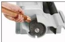
Le disque à ébavurer en option permet d'avoir un tube net pour les emboîtures
