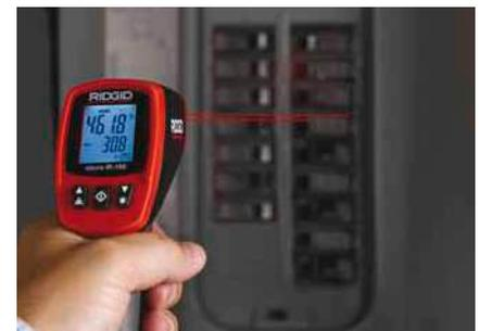
Contrôle de surchauffe de fusible ou de disjoncteur due à des circuits surchargés
