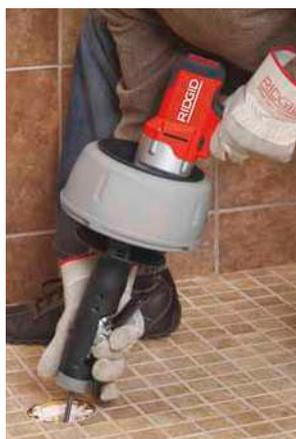
Le flexible de 3/8" (10 mm) du modèle K-45AF-5 étend les capacités de la machine jusqu'aux canalisations de 2 1/2" (75 mm)
