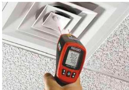
Mesure efficace de la dissipation thermique pour identifier et localiser des pertes de chaleur dans les systèmes de flux
