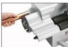
La robuste brosse de nettoyage (D.E.) nettoie rapidement et sans difficultés les tubes en cuivre de 1/2" ou 2" (12 - 54 mm)
