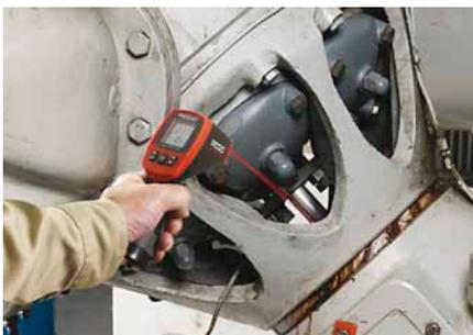
Diagnostic de température des pièces d'usure à des fins d'entretien préventif
