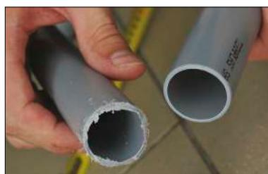
Coupe avec une scie (à gauche) et avec le P-TEC 3240 (à droite)
