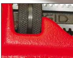
Large bride empêchant l'écrou de pivoter par inadvertance lorsque la clé est abaissée.
