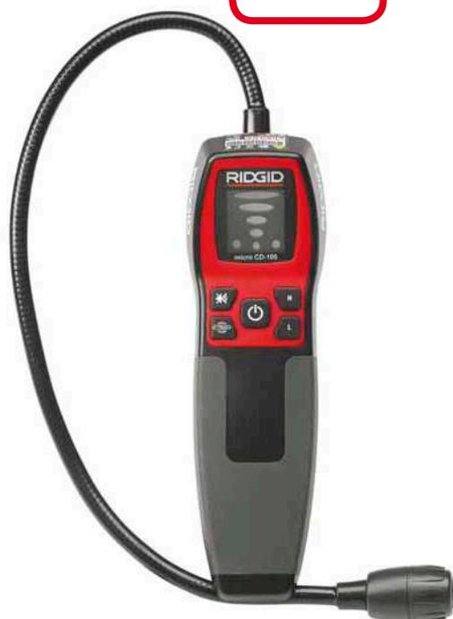
Le détecteur de gaz combustible micro CD-100 RIDGID® permet d'effectuer des relevés simples et rapides pour identifier la présence de gaz combustibles. Il est conçu pour détecter le méthane, le propane, le butane, l'éthanol, l'ammoniaque, l'hydrogène ainsi que de nombreux autres gaz combustibles. Son réglage de la sensibilité permet de détecter les niveaux de gaz les plus faibles en quelques secondes seulement.
