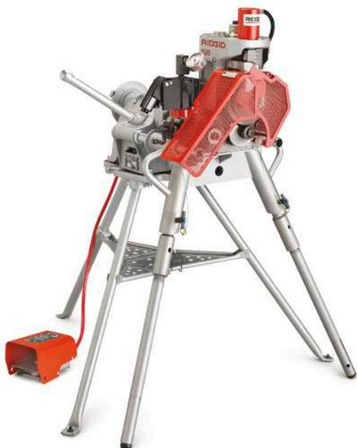
La rainureuse RIDGID® 920 repousse encore plus loin les limites du rainurage. Sa capacité de rainurage de tube de 2" - 24" de diamètre est la plus élevée de toutes les rainureuses RIDGID®. Le modèle 920 se fixe sur la machine RIDGID® 300 pour une utilisation sur site ou en atelier. Le support de tube de grand diamètre modèle RJ-624 permet de rainurer des tubes jusqu'à 24" de diamètre et complète idéalement la rainureuse 920 (voir page 2.5).
