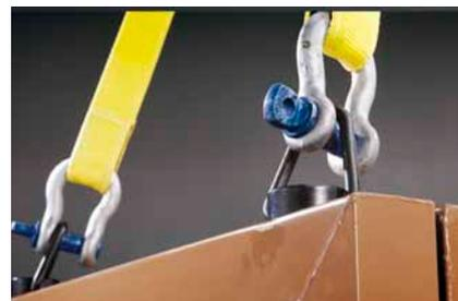
Un système de levage à quatre points permet un équilibre central plus sûr qu'avec des systèmes de levage à deux points ou à barre et fournit une capacité de poids nominal brut de 1.100 kg.
