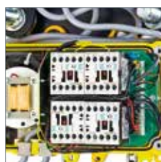
Sécurité augmentée grâce à la commande très basse tension 42 V
